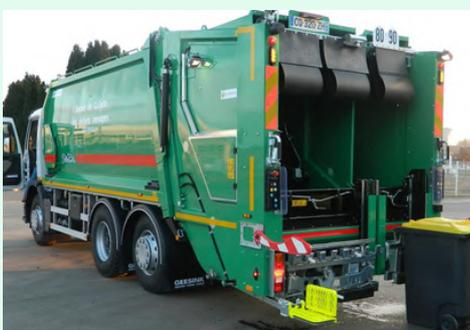
Vous voulez comprendre le système de collecte du SIRTOM ? Venez voir une benne bi-compartmentée en action. Ce type de benne permet de bien séparer les ordures ménagères et le tri sélectif !
